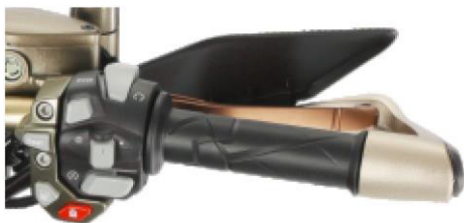
Pulsador luz de freno delantero
