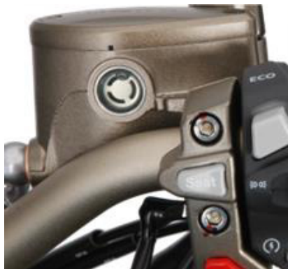
Líquido de frenos delantero
