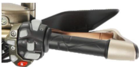
Pulsador luz de freno delantero
