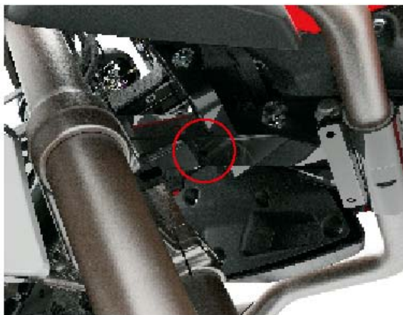
Ajuste de la altura del haz del faro
