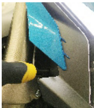
Ajuste de la altura del haz del faro
