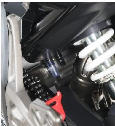
Libere la abrazadera con unos alicates de punta largos. Retire el tubo y vacíe el contenido de aceite en un punto limpio. Vuelva a montar el tubo en su sitio siguiendo el orden inverso.
