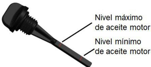
Para conseguir la máxima durabilidad del motor, es muy importante utilizar aceite motor de alta calidad y cambiar el aceite según se indica en la tabla de mantenimiento. Comprobar el nivel de aceite y cambiarlo periódicamente son dos importantes tareas del mantenimiento de la motocicleta.
