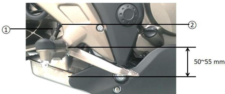
1. Afloje la contratuerca (1), gire el tornillo (2), el pedal de freno debe encontrarse 50-55 mm por debajo de la punta del pie derecho.
