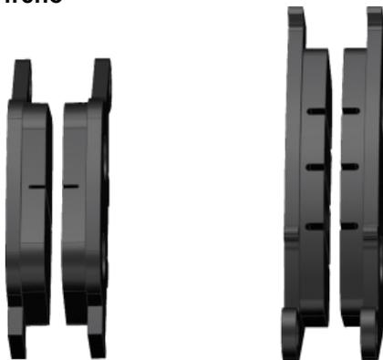
Compruebe si las pastillas de freno delanteras y traseras están desgastadas o próximas a su límite de desgaste. Si han alcanzado el límite de desgaste (el material ha alcanzado el fondo de las ranuras) confíe el cambio de pastillas a un Vendedor Autorizado.
