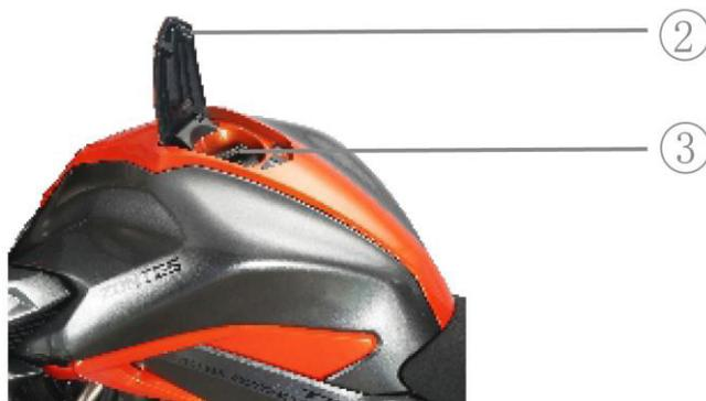
El depósito de gasolina se encuentra delante del asiento. Para repostar gasolina deberá abrir la tapa de acceso al tapón. Asegúrese de que el motor esté parado, y pulse el botón del depósito de gasolina (1), la tapa (2) se abrirá automáticamente, gire el tapón (3) del depósito de gasolina en sentido antihorario. Para cerrar el depósito, siga el orden opuesto al descrito.
