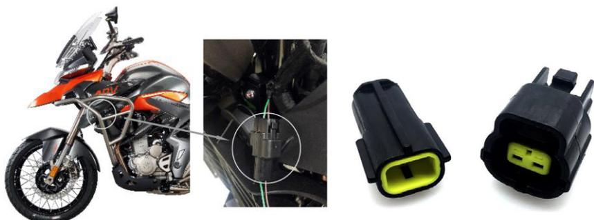
La motocicleta cuenta de serie con un conector situado bajo el depósito de gasolina por el lado izquierdo como muestra la imagen. El conector es hermético y suministra energía sólo cuando el motor está en marcha, pudiendo conectarse faros auxiliares sin dañar los circuitos eléctricos originales. Utilice la ficha especialmente destinada a esos fines y no supere los 55W de consumo total.
