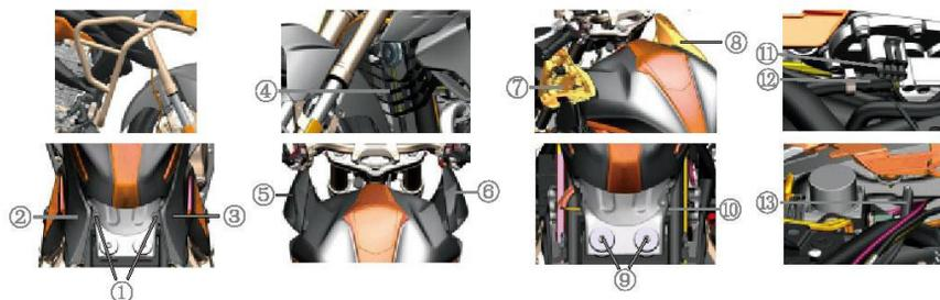
Para desmontar el depósito necesitará llaves Allen de 4 y 6 mm, alicates y un destornillador con punta tipo Philips (estrella) para desmontar todos los remaches plásticos reutilizables (hundiendo el pin central del remache con la punta del destornillador) de las piezas plásticas que forman la carrocería y carenados que envuelven el depósito.
